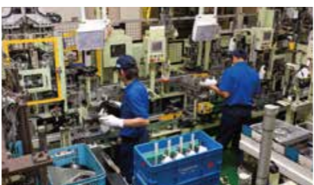
Brake booster & master cylinder assembling ブレーキブースタ&マスタシリンダ組立
